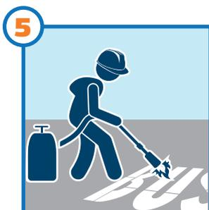
**5** SCALDARE IL PREMARK CON UN BRUCIATORE A GAS.
