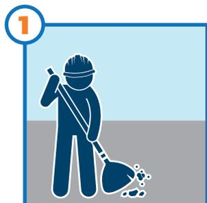
**1** PULIRE L'AREA DELL'APPLICAZIONE RIMUOVENDO SABBIA, SPORCO, SOSTANZE CHIMICHE E OLEOSE. USARE UNA SCOPA O ARIA COMPRESSA PER PULIRE LA SUPERFICIE.
